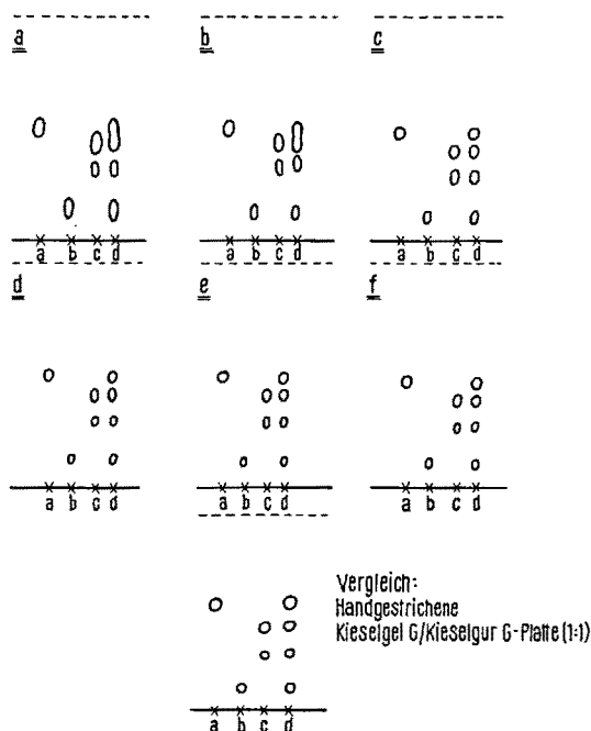
Fig. 3. Chromatographie der Testsubstanzen (optische Aufheller siehe Text) auf gefüllten Papieren aus 2,5 g Zellstoffgemisch: 80% Aspa-Birkesulfat- und 20% Fichtesulfat-Zellstoff mit steigendem Mahlgrad und 7,0 g Kieselgel G/Kieselgur G = 1:1 pro 314 cm 2 Blattfläche: (a) 22,5° SR, (b) 28,5° SR, (c) 43,5° SR, (d) 61,5° SR, (e) 68,5° SR, (f) 72,6° SR. Fließmittelsystem: Cyclohexan: Äthylmethylketon: Isopropanol = 20:1:1.
